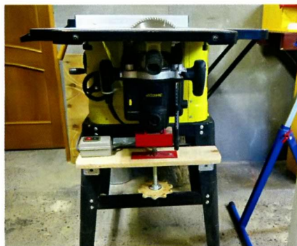
К столу циркулярного станка добавлен фрезер. Для регулировки вылета фрезы изобрел самодельный лифт. Он очень простой, но удобный и точный.
